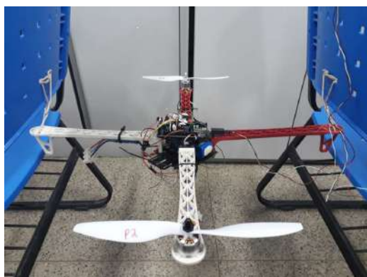
Figura 1: Sistema de balanço horizontal analisado, sustentado por cordas. Fonte: Martins (2018)
