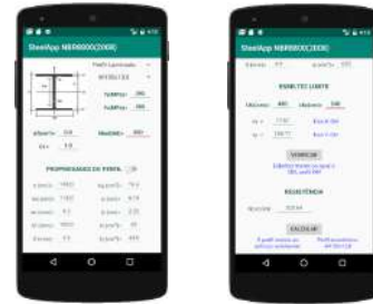
Figura 2: Verificação de elemento de aço sob tração
