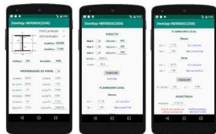
Figura 3: Verificação de elemento de aço sob compressão
