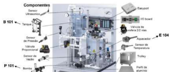
Figura 1: Bancada didática MPS-PA – Estação Compacta. Fonte: HELMICH, 2008
