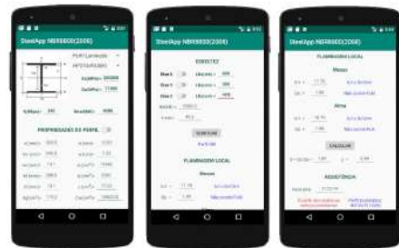
Figura 3: Verificação de elemento de aço sob compressão
