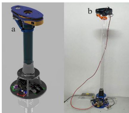
Figura 1: a) Modelo 3D da Planta de Levitação a Ar com Íris. b) Foto da planta real.
